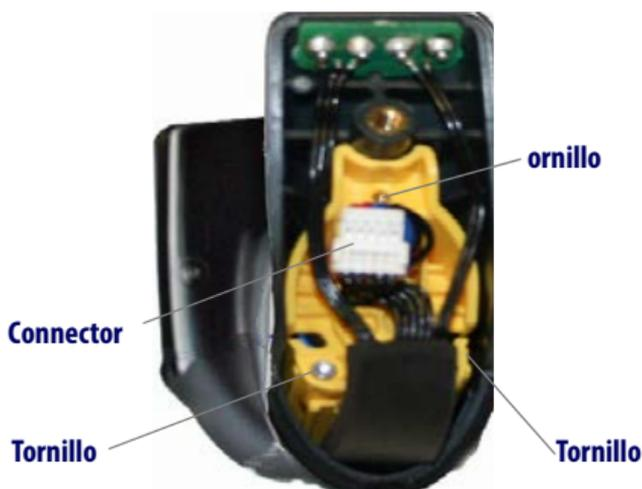
3. Mueva cuidadosamente el circuito con contactos dorados, y remueva el cartucho de la pila, dejando que el conector blanco pase por el agujero en el cartucho de la pila, según se demuestra a continuación.
